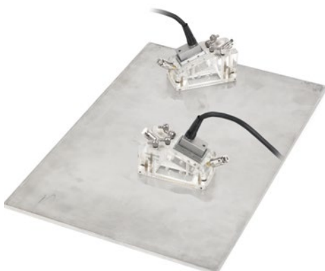
Sondas y suelas phased array (multielementos) con orientación recta para la identificación de defectos longitudinales y oblicuos.
