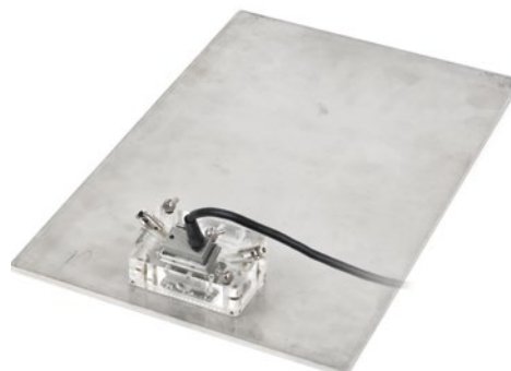
Orientação lateral das sondas e calços Phased Array para identificação de defeitos oblíquos e longitudinais.
