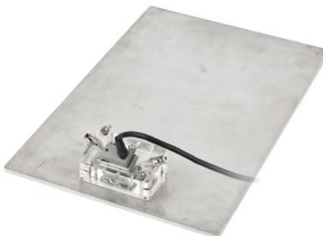
ФР-преобразователи и призмы поперечной ориентации для выявления продольных и наклонных дефектов.
