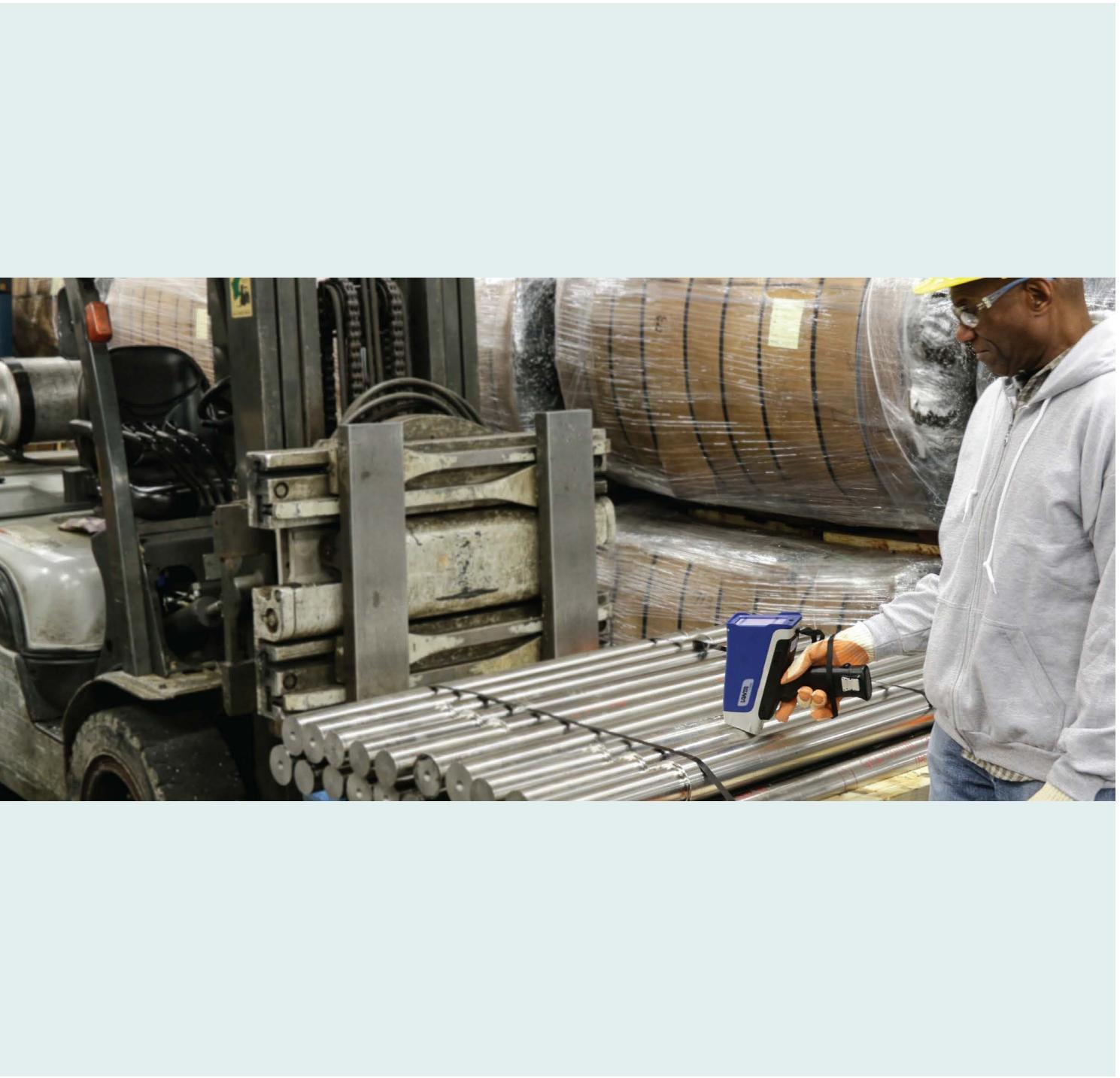
随着回收金属价格的波动，要想在回收行业盈利，快速轻松地辨别合金牌号已经成为一个必不可少的条件。用于废料分拣的Vanta手持式XRF分析仪可以在几秒钟之内对大多数合金和纯金属进行可靠的辨别。
