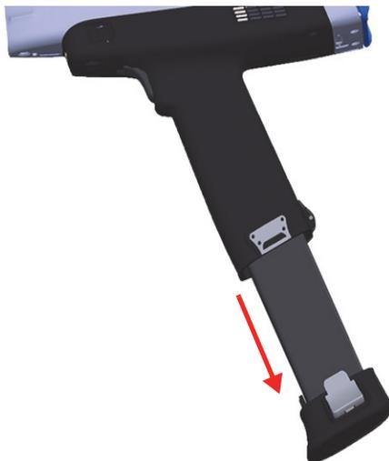
3. Alinhe os contatos da bateria carregada com os contatos da pega do Vanta e, em seguida, insira a bateria na pega.
