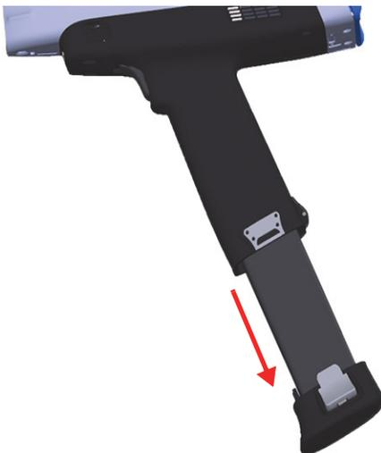
3. Вставьте полностью заряженную батарею в ручку анализатора Vanta, совместив контакты. Форма ручки анализатора позволяет вставить батарею единственно верным образом.
