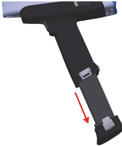
3. Alinee los contactos de la batería completamente cargada con los contactos de la empuñadura del analizador Vanta y, después, introduzca la batería en la empuñadura. La empuñadura tiene muescas para que la batería pueda introducirse de una sola forma.
