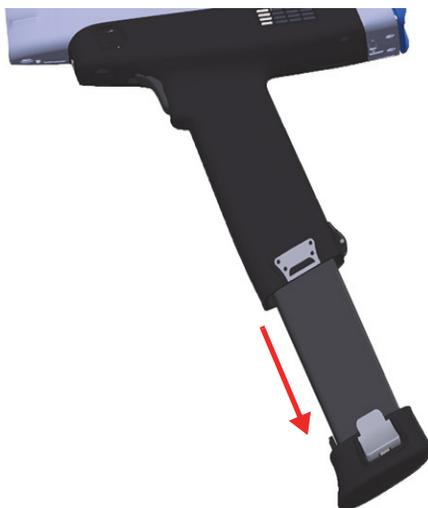
3. Alignez les contacts d'une batterie complètement chargée avec les contacts situés dans la poignée du Vanta, et puis insérez la batterie dans la poignée.
