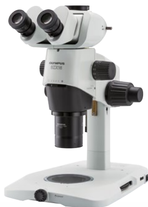
Štíhlé provedení SZX16, procházející světlo LED, kombinace s osvětlovací základnou SXZ2-ILLTQ
