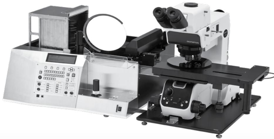
AL120 Waferloader (200-mm-Modell) mit dem MX63 Mikroskop für die Halbleiter-Prüfung
