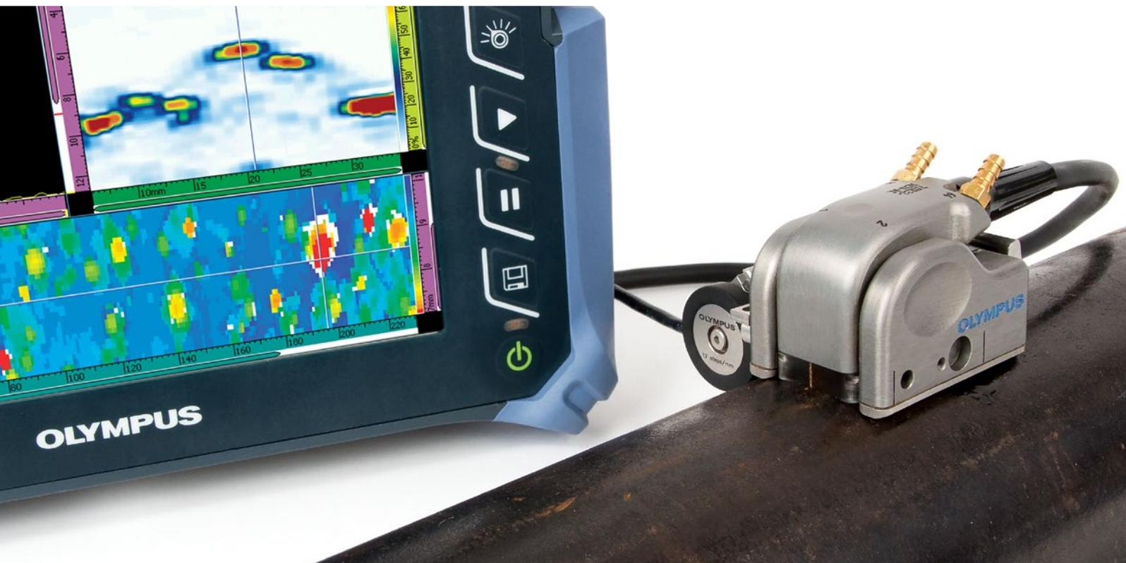
用于腐蚀检测的新型双晶线性阵列（DLA）探头，与常规超声双晶探头相比，具有更多优势特性。这种相控阵解决方案，通过诸如更大的声束覆盖范围、更快的扫查速度，及具有更高数据点密度的C扫描成像等特性，提高了检测效率。与标准的相控阵脉冲回波相比，这款新探头所使用的一发一收技术在腐蚀测量应用中可提供更好的近表面分辨率及更好的点蚀探测能力，从而可提高危害性壁厚减薄的探出率。
