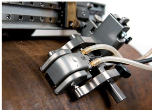
在自动检测中与MapROVER扫查器一起使用的DLA腐蚀探头
