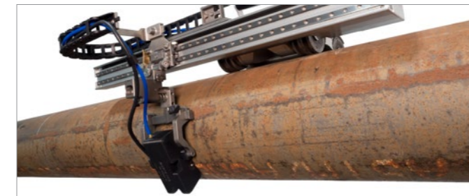
Die Vorlaufkeilserie SFA1-AUTO kann mit dem MapROVER Scanner für die Prüfung von Rohren in Längsrichtung eingesetzt werden.
