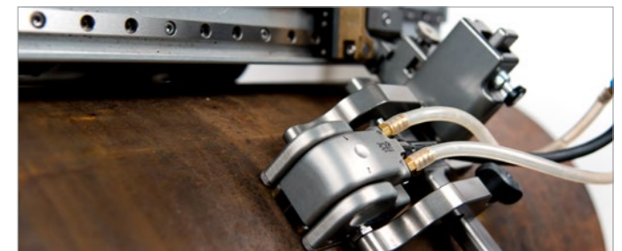
Der DLA-Korrosionssensor kann in Verbindung mit dem MapROVER Scanner für automatisierte Prüfungen eingesetzt werden.
