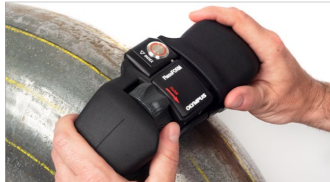
FlexoFORM Scanner erstellt mit integriertem Weggeber und Taktgeber eine C-Bild bei der Prüfung eines Rohrbogens
