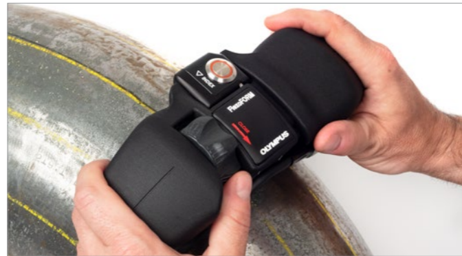
Escáner FlexoFORM ejecutando un mapeo C-scan en un codo con el codificador integrado y el botón de indexación.
