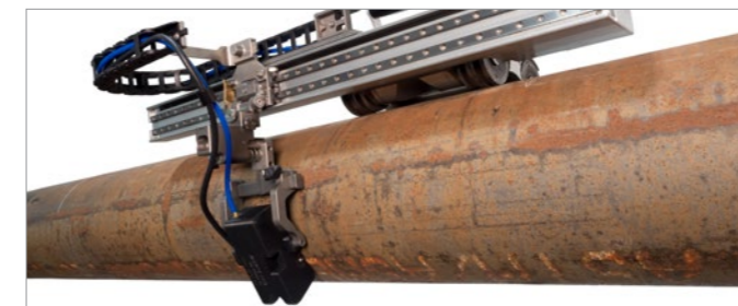
La serie de suelas (zapatas) SFA1-AUTO puede ser usada con el escáner MapROVER para inspeccionar tuberías en dirección longitudinal.
