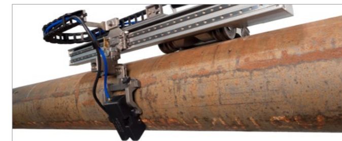
Les sabots de la gamme SFA1-AUTO peuvent être utilisés avec le MapROVER pour l'inspection longitudinale des tuyaux.
