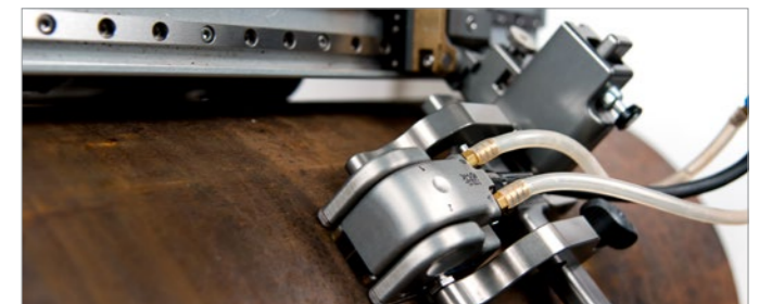
La sonde DLA pour la corrosion peut servir à effectuer une inspection automatisée lorsqu'elle est utilisée avec le scanner MapROVER.
