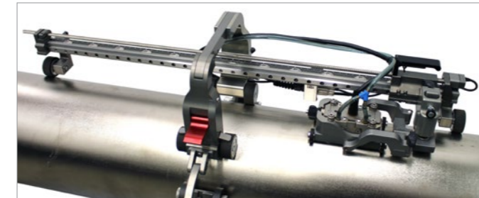
Le MapSCANNER™ est un scanner à deux axes optimisé pour la cartographie de la corrosion. Ici, il est assemblé avec le scanner HydroFORM.
