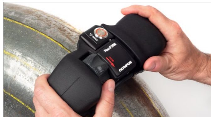
Cartographie C-scan d'un coude à l'aide du scanner FlexoFORM équipé du codeur et du bouton d'indexation intégrés.
