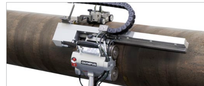
Lo scanner HydroFORM può essere usato con lo scanner MapROVER™ per eseguire l'ispezione di tubazioni in direzione circonferenziale.
