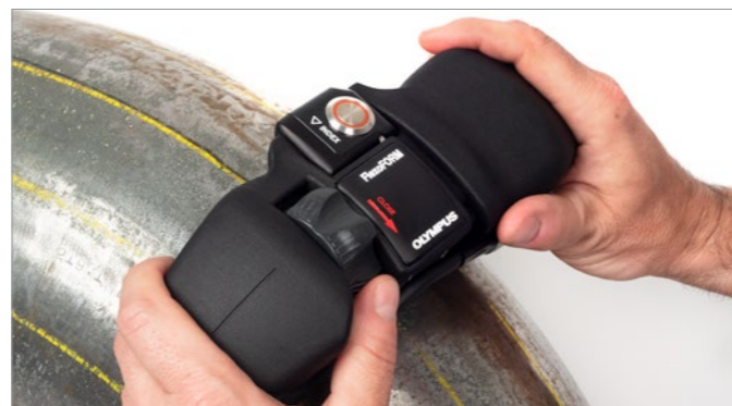
Esecuzione di mappature C-scan da parte di uno scanner FlexoFORM su un raccordo a gomito mediante un encoder integrato e un pulsante di indicizzazione.
