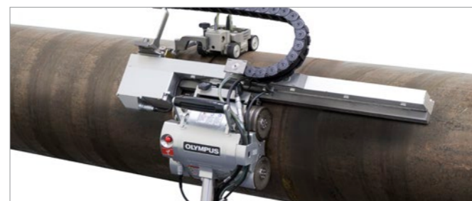
HydroFORM スキャナーを MapROVER スキャナーと共に使用すると、パイプの円周方向の検査を実行できます。
