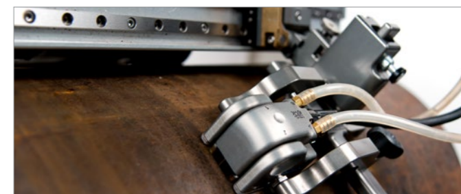
DLA 腐食検査用プローブは、MapROVER スキャナーと組み合わせると自動検査を実行できます。
