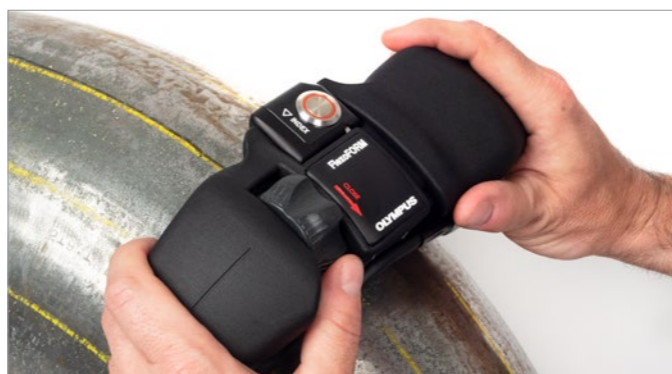
一体型エンコーダーとインデックスボタンを使用してエルボーの C-スキャンマッピングを実行している FlexoFORM スキャナー。
