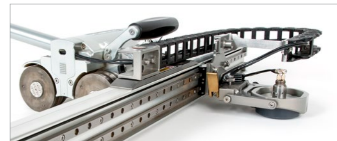
モーター駆動式スキャナーの MapROVER は、二振動子型探触子による従来型 UT プローブを使用した検査にも対応できます。
