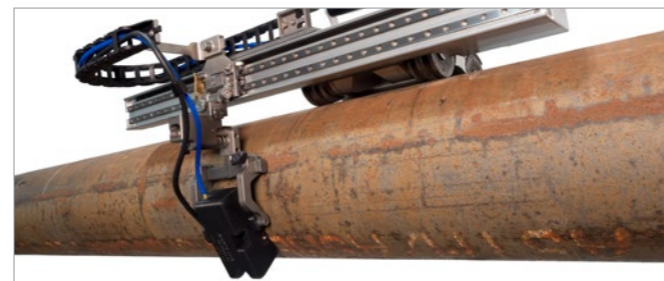
SFA1-AUTO ウェッジを MapROVER スキャナーと共に使用すると、パイプの縦方向の検査を実行できます。
