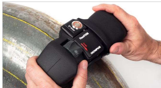
FlexoFORM scanner realizando o mapeamento de C-scan em um cotovelo com um codificador integrado e botão indexador.
