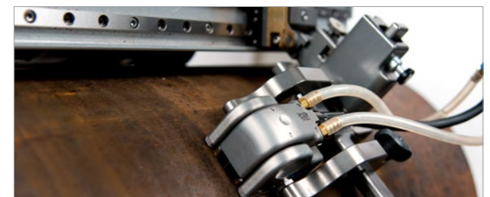
A sonda DLA para corrosão pode ser usada para fazer inspeções automáticas quando utilizada com o MapROVER scanner.
