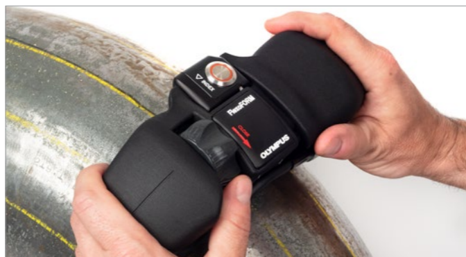
Сканер FlexoFORM, выполняющий картирование C-скан на патрубке с использованием встроенного кодировщика и кнопки индексации.
