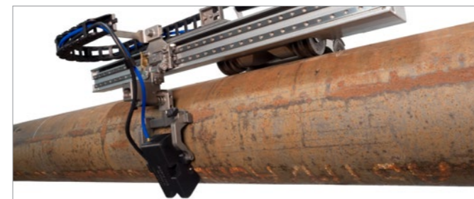
Призма SFA1-AUTO может использоваться со сканером MapROVER для продольного сканирования труб.
