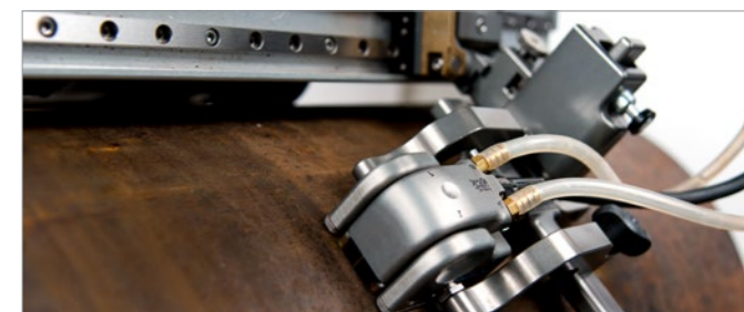
Преобразователь DLA в комбинации со сканером MapROVER используется для автоматизированного контроля коррозии.
