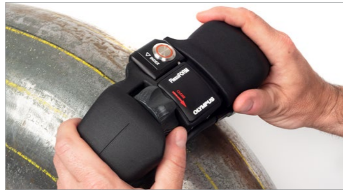
FlexoFORM扫查器通过使用整合的编码器和步进点击按钮为弯头部件进行C扫描成像操作。
