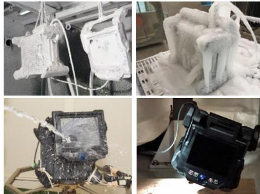
**Zuverlässig und haltbar** entspricht das IPLEX NX den strengen Militärnormen, wie z. B. MIL-STD-810G/461F und IP55 (staub- und wasserdicht). Das Einführungsteil ist hitzebeständig bei Temperaturen bis zu 100 °C. Dies bedeutet, dass das Prüfobjekt nicht abkühlen muss, sondern schnell weiter geprüft werden kann.
