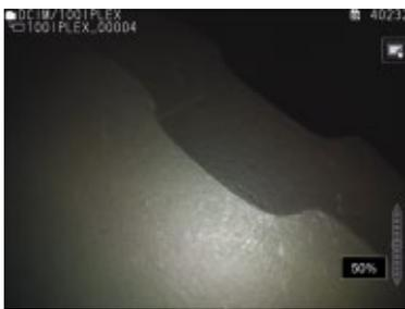
**Função Ghost Image (imagem fantasma)** auxilia na comparação de inspeções. As imagens armazenadas no IPLEX NX podem ser sobrepostas às imagens exibidas em tempo real e comparadas com as condições atuais.
