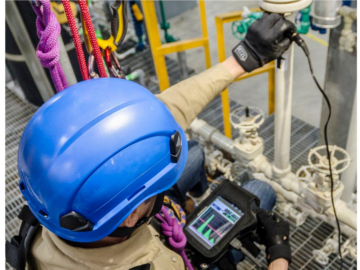
EPOCH 6LT探伤仪的工作流程非常简单直观。其主屏幕显示的是较大的、经过优化的A扫描，其中包含一些访问常用功能的链接。通过使用改进的扫查工作流程，检测人员只需按下一个按钮，稍微做一些调整，就可以完成他们的检测。当检测人员需要浏览菜单时，容易辨识的图标可使他们轻松地找到所需的功能。
