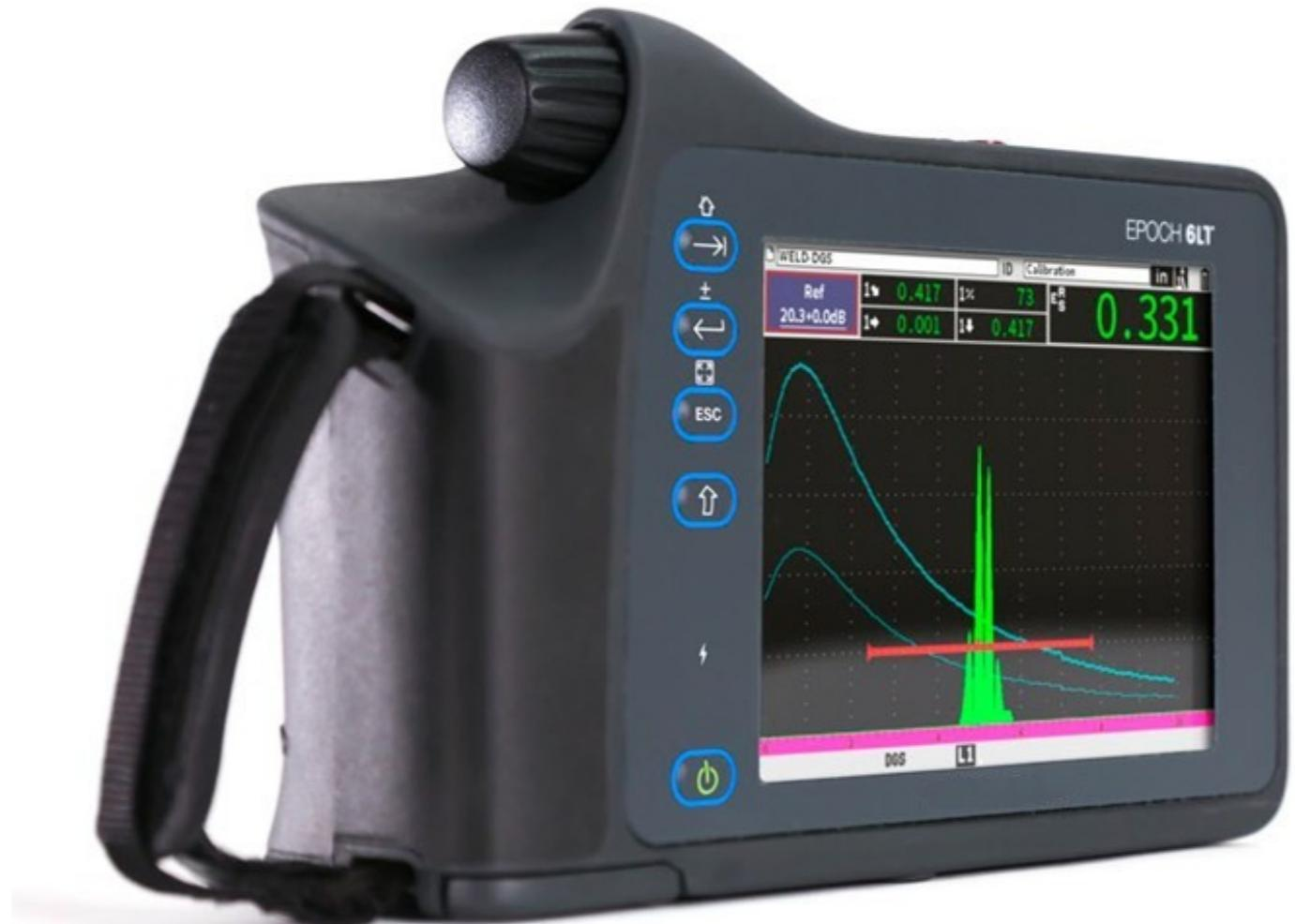
EPOCH 6LT探伤仪既坚固耐用，又使用方便，检测人员仅用单手就可以操控这款仪器，快速有效地完成借助绳索攀爬完成的检测。而且，这款仪器还可正常运行极长的时间。
