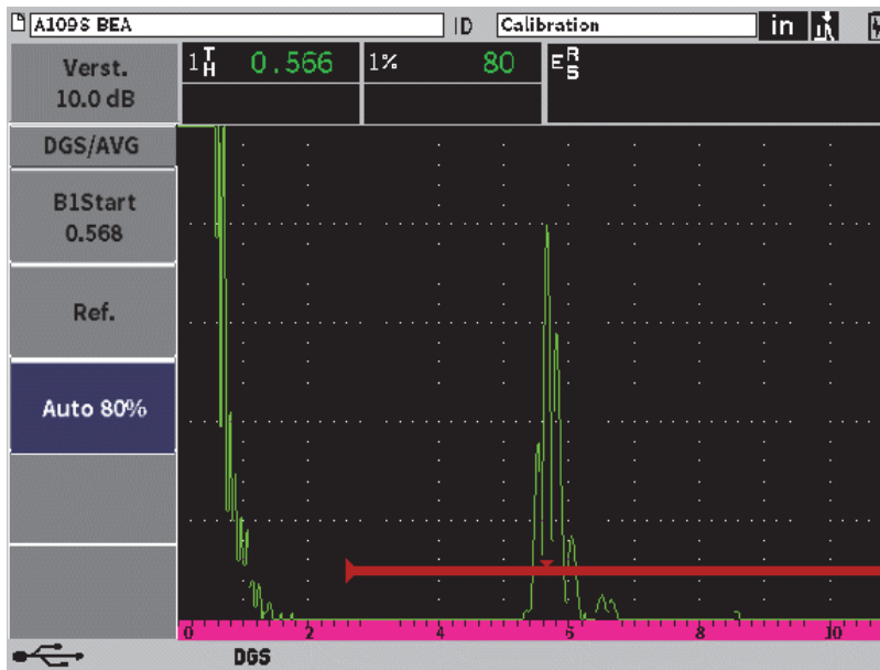
Abbildung 11-20 Referenzreflektor vor der Erfassung
