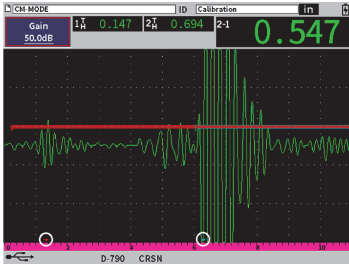
图 11-43 回波到回波测量
