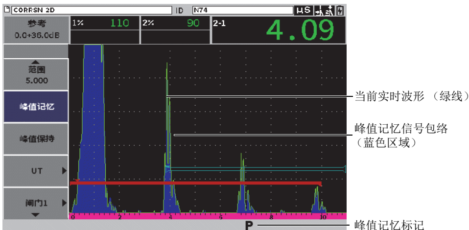
图 7-11 峰值记忆信号包络示例
