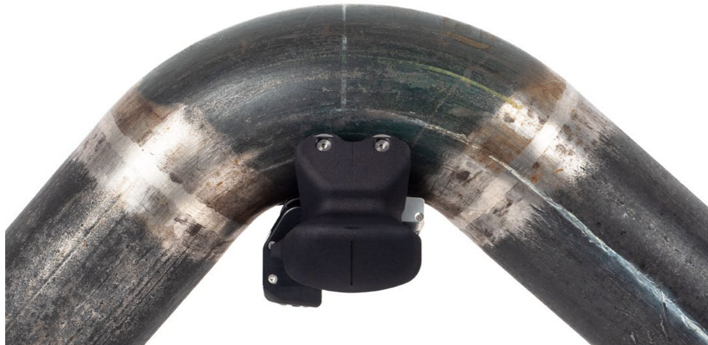
Der FlexoFORM Scanner zur Prüfung von Rohrbögen mit einem AD von 4,5 Zoll.
