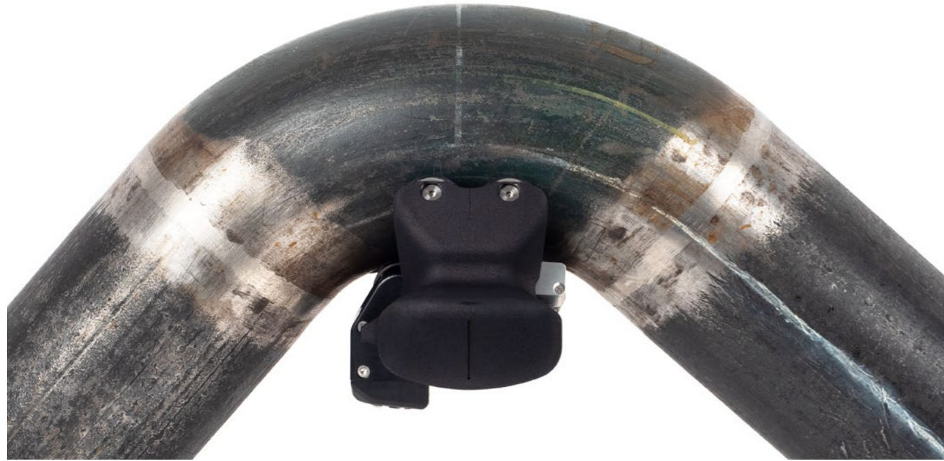
Scanner FlexoFORM inspectant l'intrados d'un coude de tuyau d'un diamètre extérieur de 4,5 po.
