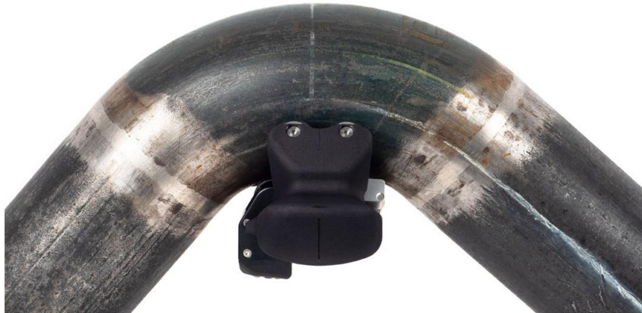
Lo scanner FlexoFORM ispeziona gli intradossi di un raccordo a gomito con diametro esterno di 11,43 cm.
