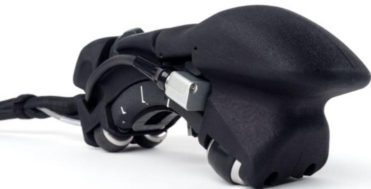
L'innovativo scanner FlexFORM™ facilita le complesse ispezioni della corrosione nei raccordi a gomito delle tubazioni. Mediante la tecnologia phased array flessibile, è sufficiente usare una sonda per coprire tutti i diametri di raccordi a gomito.
