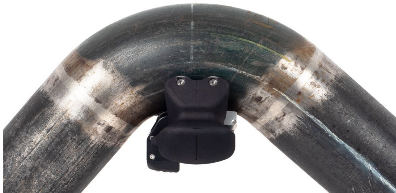
外径 4.5 インチのパイプエルボ-の内輪を検査する FlexoFORM スキャナー
