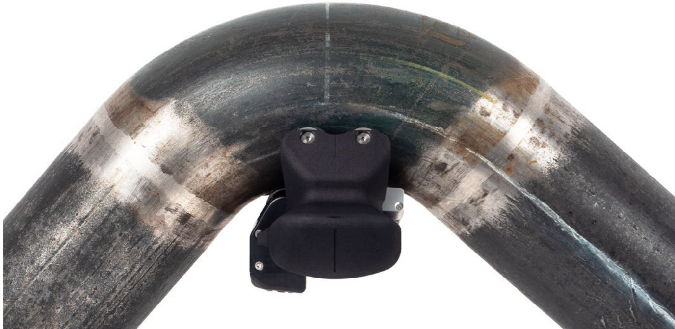
FlexoFORM inspecionando intrados do cotovelo de um tubo com diâmetro externo de 4,5 pol.
