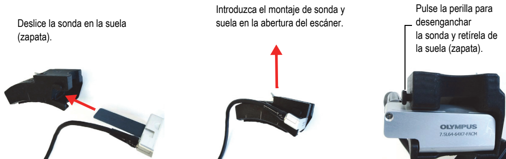
Figura 2-3 Instalación de sonda y zapata (suela)
