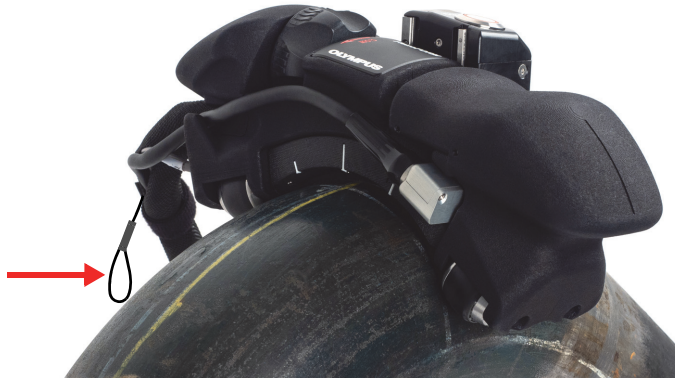
Figura 3-1 Punto de enganche para el cordón
