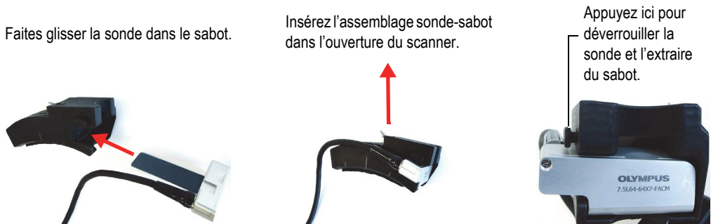
Figure 2-3 Installation de la sonde et du sabot
