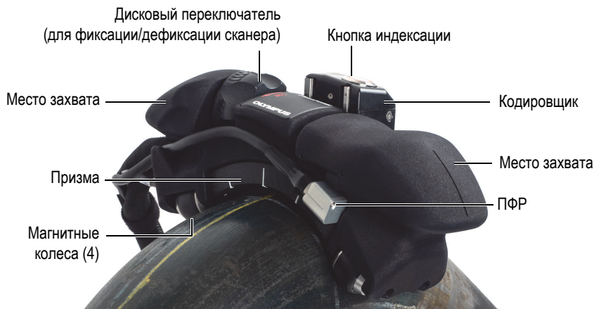
Рис. 1-2 Компоненты сканера
