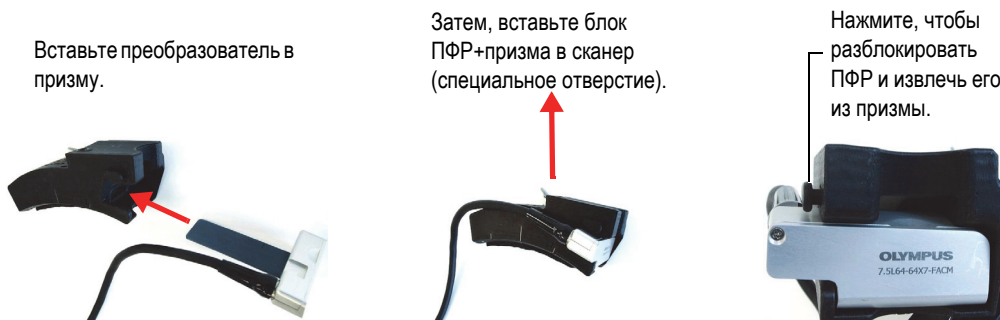
Рис. 2-3 Установка преобразователя и призмы
