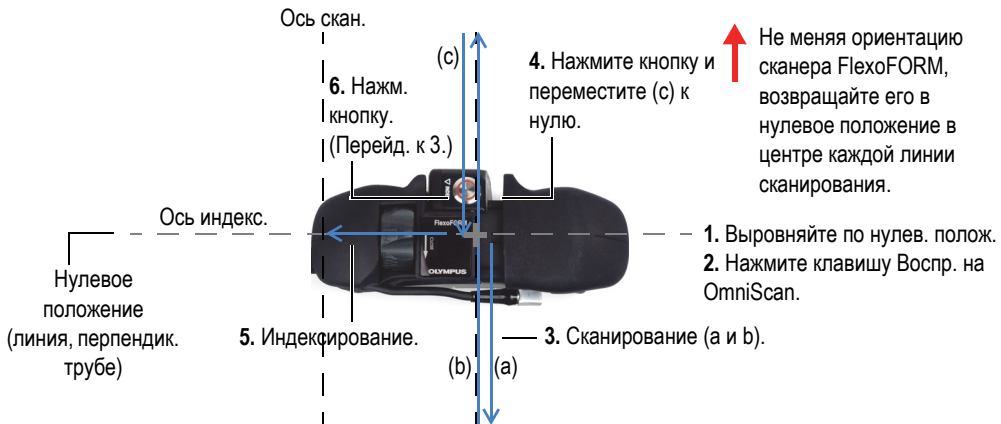
Рис. 4-3 Схема сканирования для колена трубы
