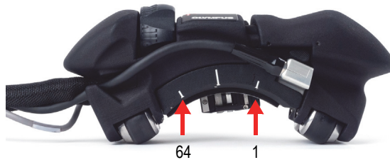
Рис. 4-4 Отметки элементов ПЭП на призме
