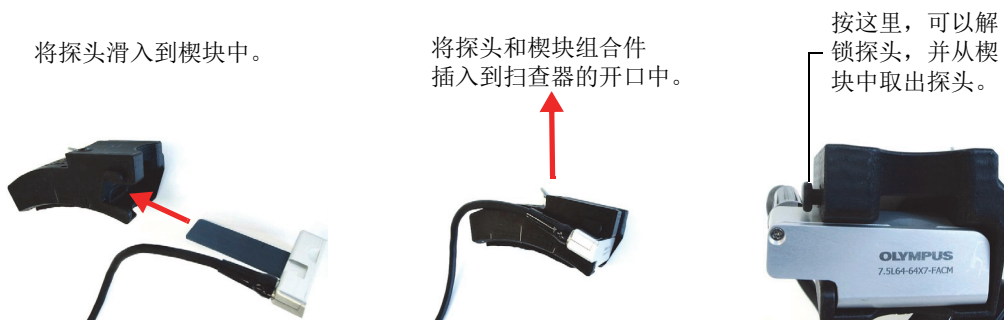
图 2-3 安装探头和楔块
