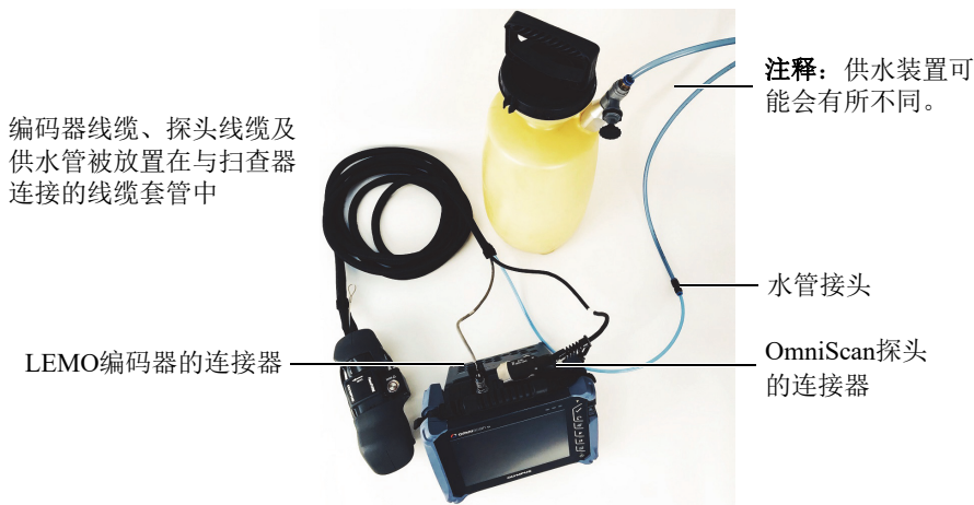
图 2-4 扫查器相关线缆的连接情况
