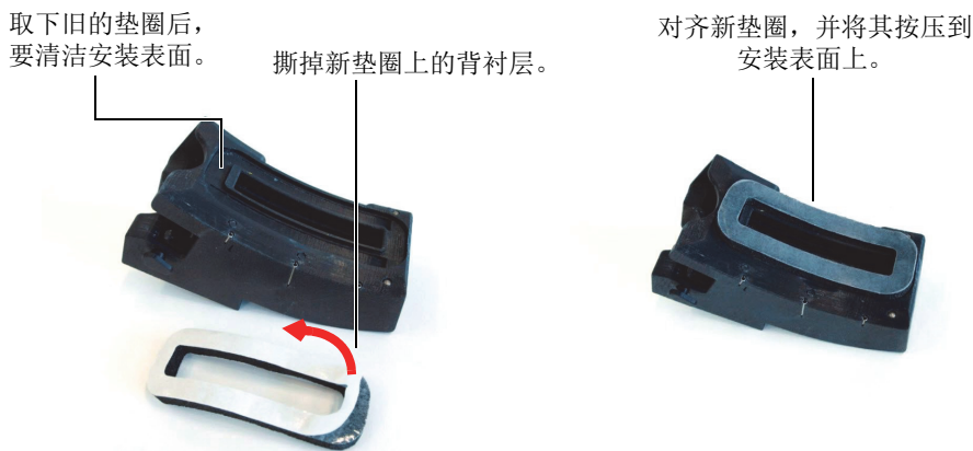
图 5-3 更换泡沫垫圈
