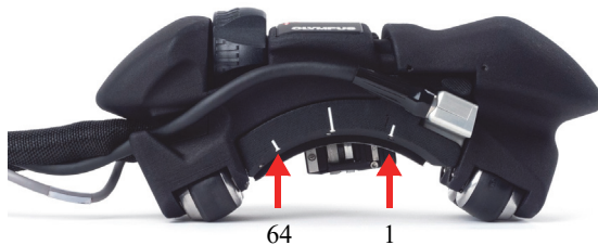
图 4-5 楔块上的探头晶片标记
