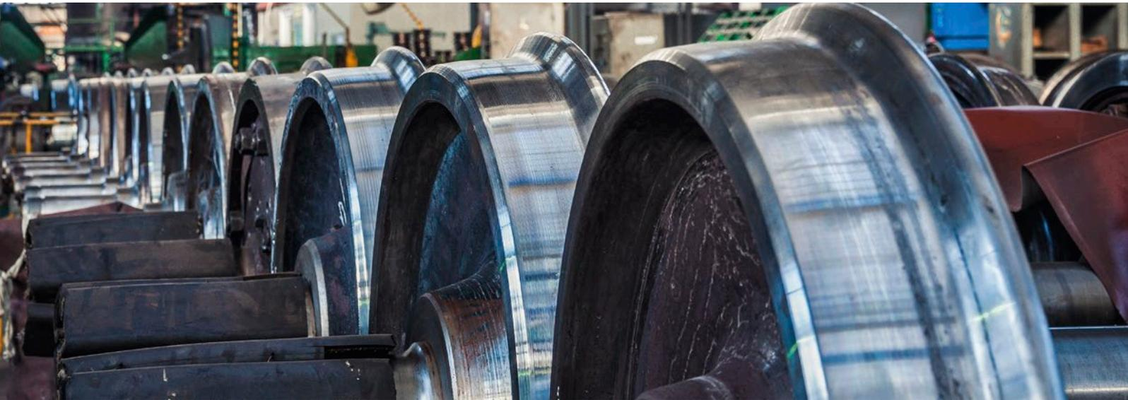
Le ruote dei treni sono fabbricate usando una delle diverse qualità di lega accettate dall'industria, con la resistenza richiesta, e adottando i due principali processi di produzione: la forgiatura e la pressofusione. Le ruote di treni hanno diversi diametri, profili e pesi in funzione della ferrovia sulla quale devono essere usati. Per prevenire incidenti ferroviari, i requisiti e le norme che regolano la qualità delle ruote dei treni sono sempre più esigenti.
