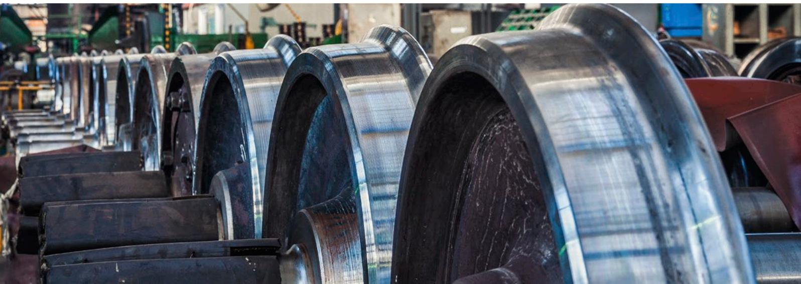
火车轮是由具有所需硬度的某种符合标准的钢材料，通过锻造和铸造两种主要工艺制造而成。根据所行驶的不同铁路，需要制造不同直径、形状、重量的火车轮。为了避免铁路事故的发生，用于管理火车轮质量的要求和标准越来越严格。
