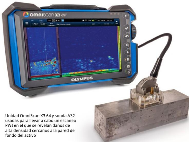
Unidad OmniScan X3 64 y sonda A32 usadas para llevar a cabo un escaneo PWI en el que se revelan daños de alta densidad cercanos a la pared de fondo del activo
