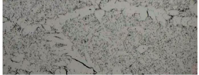
Imagen micrográfica del daño por HTHA
