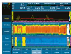
Pantalla mostrando un A-scan, un C-scan de amplitud, y un C-scan con la técnica TOF.
