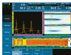
Pantalla mostrando un A-scan, S-scan y un C-scan de amplitud.
