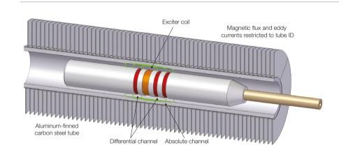
Метод ближнего поля для контроля оребренных труб использует обычный ВТ-преобразователь с возбуждающей и принимающей катушками без наружной катушки опорного сигнала. Преобразователь генерирует простые для анализа сигналы. Преобразователь измеряет зазор или коэффициент заполнения и преобразуют его в амплитудный сигнал.
