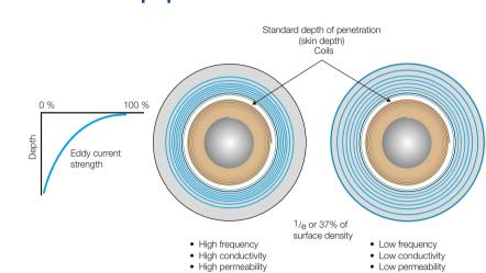
Плотность вихревых токов в материале непостоянна. Наибольшая плотность наблюдается вблизи катушки; по мере углубления в материал плотность уменьшается.
