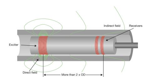
Зона, в которой доминирует «непрямое» поле, называется удаленным полем. Эта зона находится на расстоянии, превышающем два диаметра трубы.
