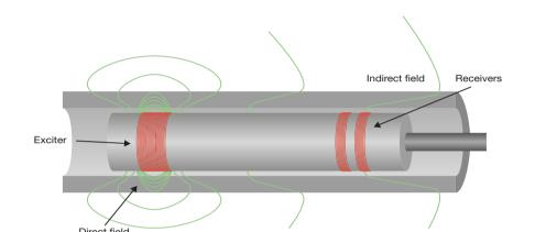
«Непрямое» поле распространяется кнаружи, пересекая стенку трубы; затем проходит вдоль оси трубы и возвращается обратно сквозь стенку трубы.
