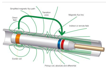
Метод удаленного поля (RFT) представляет собой метод сквозного прозвучивания, а преобразователи используются для контроля труб из ферромагнитных материалов (углеродистой стали).
