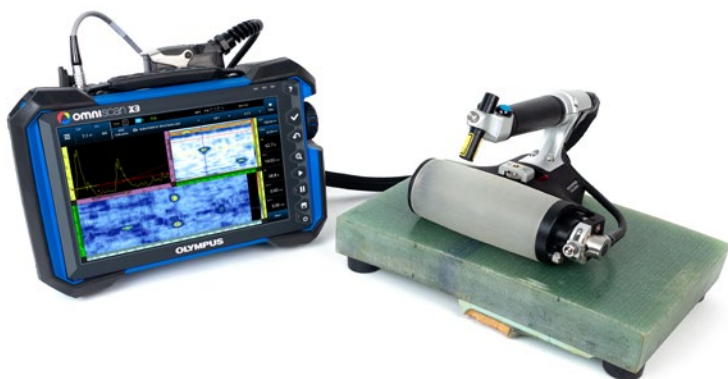
OmniScan X3 combiné au RollerFORM™ XL utilisés pour inspecter la semelle de longeron d'une pale d'éolienne
