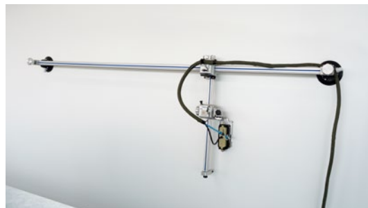
Scanner semi-automatisé sur deux axes GLIDER utilisé pour l'inspection d'une pale d'éolienne
