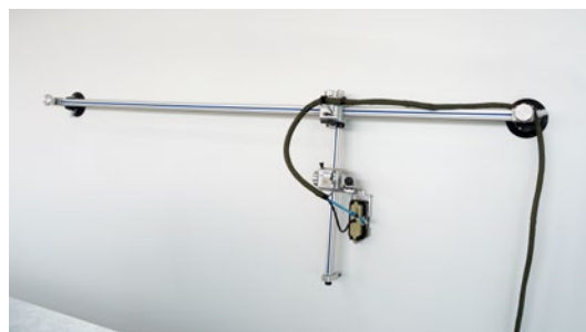
Ispezione di una pala eolica mediante uno scanner a 2 assi semi-automatizzato GLIDER
