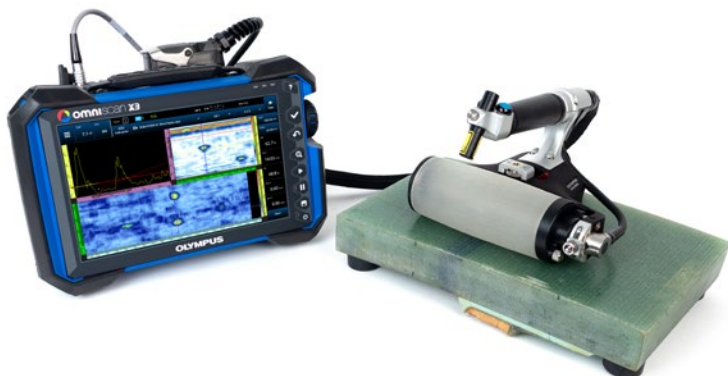
Strumento OmniScan X3 con sonda rotante phased array RollerFORM™ XL su un campione di soletta di longherone di una pala eolica
