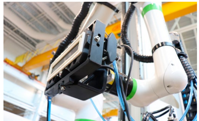
Phased-Array-Sensor und Wasserstreckenvorlaufkeil montiert am Cobot-Arm eines AGV mit einer FOCUS PX Datenerfassungseinheit (nicht abgebildet)
