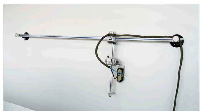
72 インチ (1.8 m) 長の GLIDER スキャナーおよび OmniScan 探傷器を使用した半自動検査
