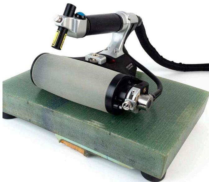
せん断ウェブに接合されたスパークャップの試料上に置かれた15プローブ、S15ホルダー（左）および1 MHz RollerFORM XL スキャナー（右）
