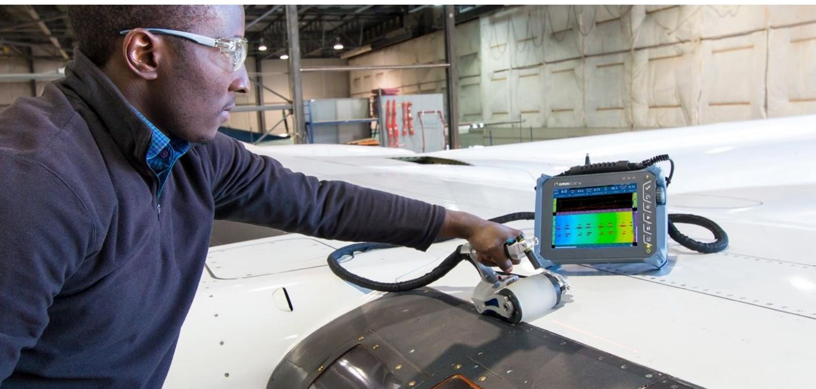
奥林巴斯的RollerFORM相控阵轮式探头用于对复合材料及其他表面光滑的材料进行检测。经济实惠、操作方便的RollerFORM扫查器可以替代全二维（2D）编码系统，提供一种与水浸技术等效的可行性检测技术。
