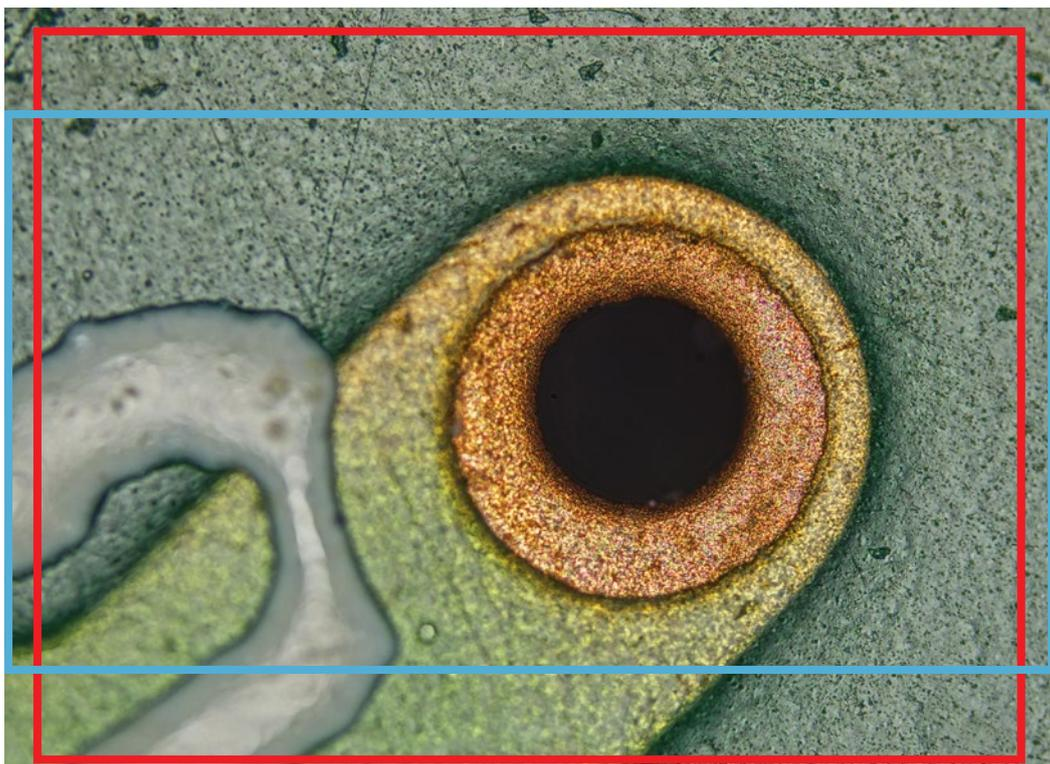
Comparación entre el campo visual de la cámara DP75, al ser usada con el adaptador de cámara 0.63× (fotograma rojo), y el campo visual de la cámara DP74 (predecesora) al usar el adaptador de cámara 0.63× (fotograma azul)
