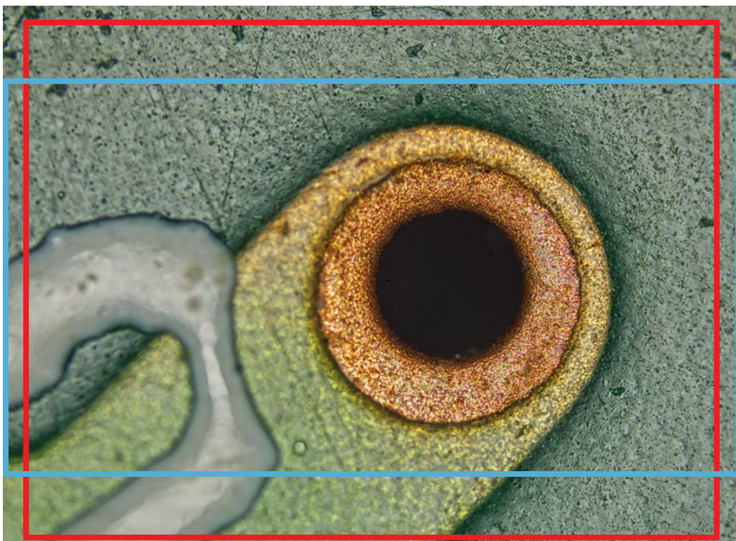
Champ d'observation offert par la caméra DP75 lorsqu'elle est utilisée avec l'adaptateur de caméra 0,63× (cadre rouge), comparé au champ d'observation offert par la caméra DP74 (modèle précédent) lorsqu'elle est utilisée avec l'adaptateur de caméra 0,63× (cadre bleu)
