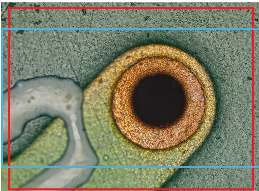
Champ d'observation de la caméra DP75 utilisée avec l'adaptateur de caméra 0,63× (cadre rouge) comparé au champ d'observation de la caméra DP74 (la version précédente) utilisée avec l'adaptateur de caméra 0,63× (cadre bleu)
