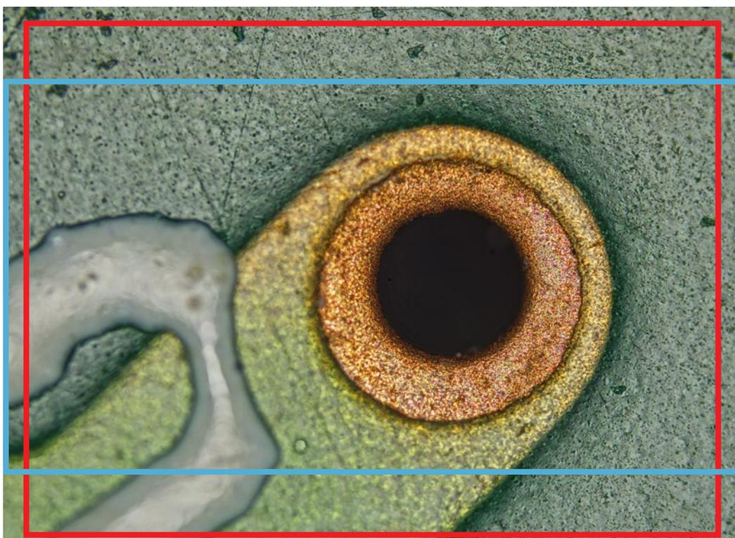
Il campo visivo della fotocamera DP75 quando usato con l'adattatore della fotocamera 0,63× (riquadro rosso) confrontato con il campo visivo della fotocamera DP74 (predecessore) quando usato con l'adattatore della fotocamera 0,63× (riquadro blu)
