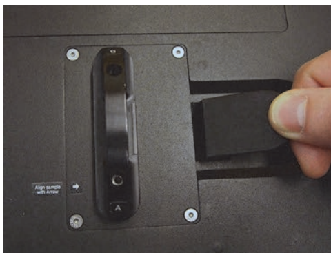
Figura 3-16 Bloqueando o suporte da amostra para baixo
