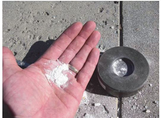
Figura 3-4 Moer a amostra
