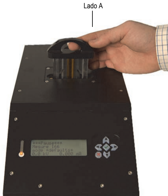
Figura 3-15 Inserir o suporte de amostras
