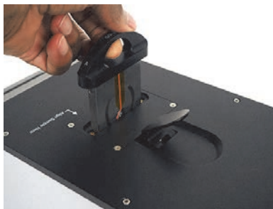
Figura 3-10 Remoção do suporte de amostra
