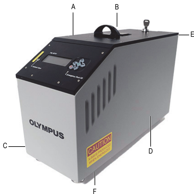
Figura 2-3 Pontos de medição de radiação
