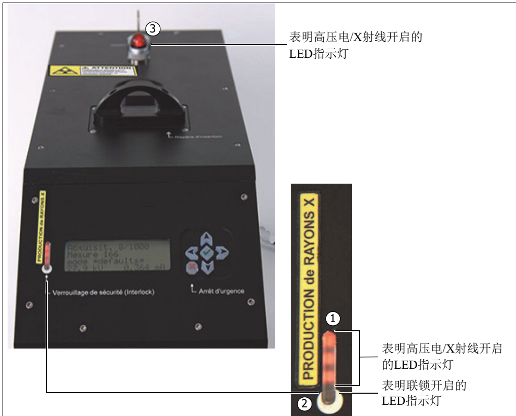
图 2-2 BTX III分析仪的LED指示灯
