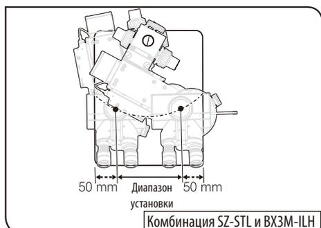
**Комбинация компонентов, приводящая к потере устойчивости микроскопа, не допускается.**
