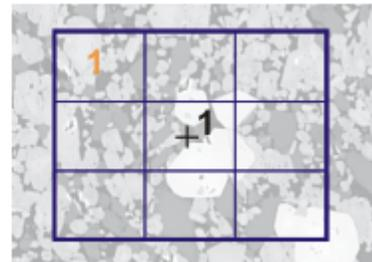
L'illustration montre un échantillon sur lequel est définie une zone d'acquisition (1). 9 images simples sont nécessaires pour enregistrer entièrement la zone d'acquisition.
