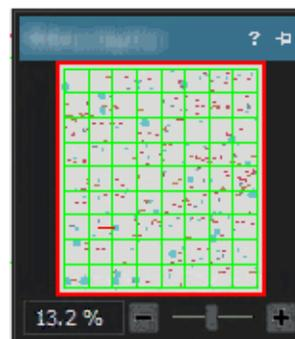
Figure gauche : Représentation des résultats dans la barre d'outils [Navigateur d'image], si l'analyse est effectuée selon la norme [ASTM E 45-18 méthode D] ou [ISO 4967:2013 méthode B]. Dans l'exemple présenté, les champs dans lesquels des inclusions appartenant au type d'inclusion actuellement sélectionné ont été détectées sont soulignés.
