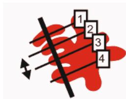
Représentation schématique d'une ligne de mesure coupant quatre branches des dendrites. La double flèche noire indique l'espacement entre la deuxième et la troisième branche de dendrite.
