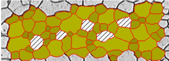
La figure ci-dessous représente le résultat d'une détection automatique des joints de grains après que certains grains ont été effacés manuellement. Les grains effacés ne sont plus pris en compte lors du calcul des résultats de mesure. Ils sont représentés hachurés dans l'image.
