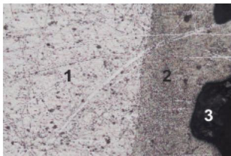
La figure montre l'image d'un échantillon avec les deux phases (1) et (2). Les zones sombres (3) n'appartiennent à aucune phase. Vous voulez mesurer l'occupation de la surface des deux phases. (1) et (2).
