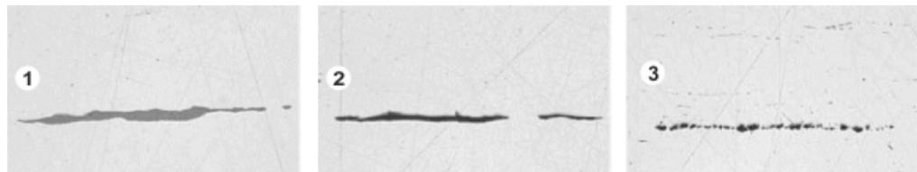
Vue microscopique de différentes inclusions dans un échantillon d'acier poli. Les inclusions se distinguent par la couleur et par la forme. Les figures montrent des inclusions de sulfure (1), de silicate (2) et d'alumine (3).
