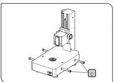
**2** 運搬棒 c (4ヶ所)を持って本体を持ち上げて運搬し、設置台に 載せます。
