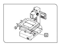
9 ステージのXY軸をそれぞれ移動し、ステージベースの取付け穴 kにステージ付属の固定ねじを差込み、ステージ付属の六角レ ンチで固定します。
