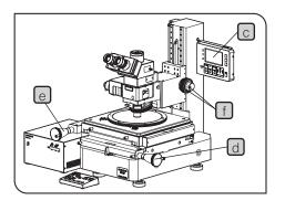
4 カウンタの表示部でが点灯します。 X軸ハンドルは、Y軸ハンドルで、粗微動ハンドルでまたは 電動オペレーションユニットSTM7-MCZの粗微動ハンドルを回 し、表示部が計数するか確認します。
