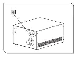
7 急峻な段差や大きな段差を追従させる場合には、合焦位置を見失い追従できなくなることがあります。(オートフォーカスユニット前面のFOCUS LED のが点滅します。) この場合、再度電動オペレーションユニットのAF START/STOPボタン f を2回押せば、再びサーチ動作を行います。
