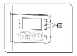
1 カウンタのX,Y,Z-RESETボタンaを同時に押しながら、コントロールボックスSTM7-CB/STM7-CBAのメインスイッチbを (ON)にします。
