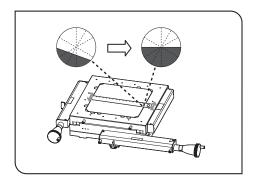
5 測定物のエッジがクロス線の中心に来るように、測定物の角度を変えます。
