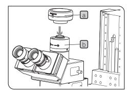
1 正面を向くように、デジタルカメラaをカメラアダプタbに取り付けます。
