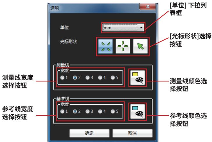
测量线的宽度(厚度)能在1和5点之间进行选择。如果对比测量目标图像中未包含任何测量结果，测量线的宽度就会设置为2点。
